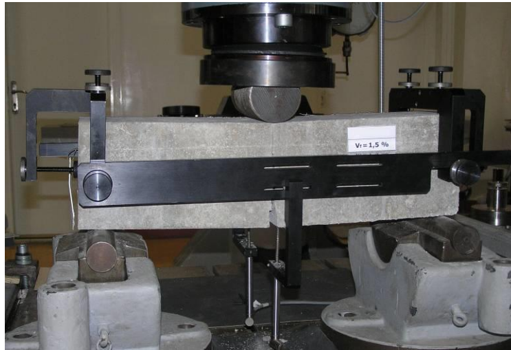
Slika 3.11 Eksperiment statičkog ispitivanja grede na savijanje pod kontrolom pomaka na gredi s V_f=1.5 \%
