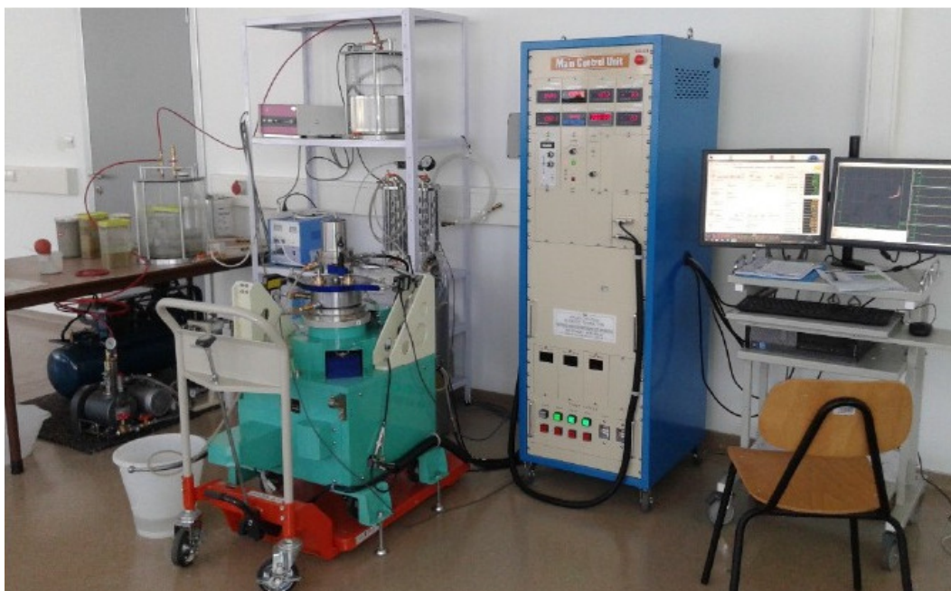
Slika 4.12 Uređaj za prstenasto smicanje ICL-1
