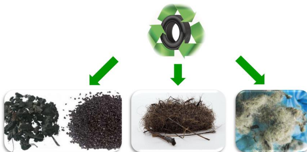
Slika 1. Shematski prikaz produkata reciklaže otpadnih auto guma
