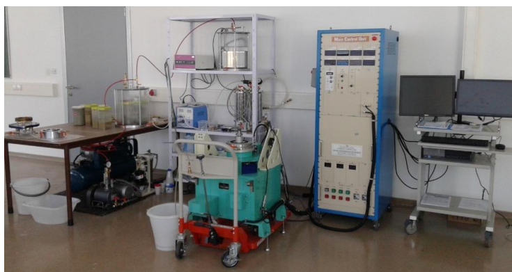
Slika 1. Novi prijenosni aparat za prstenasto smicanje, ICL-1 doniran Hrvatskoj 2010. godine (Slika: M.Vivoda)
