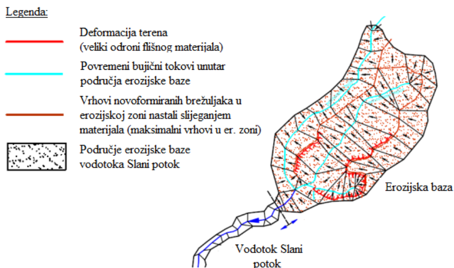
Slika 4.15. Prikaz bujičnog vodotoka Slani potok i erozijske baze za potrebe izrade računalnog koda u SOLFEC simulacijskom programu (Žic i sur., 2012b, 2012c)
