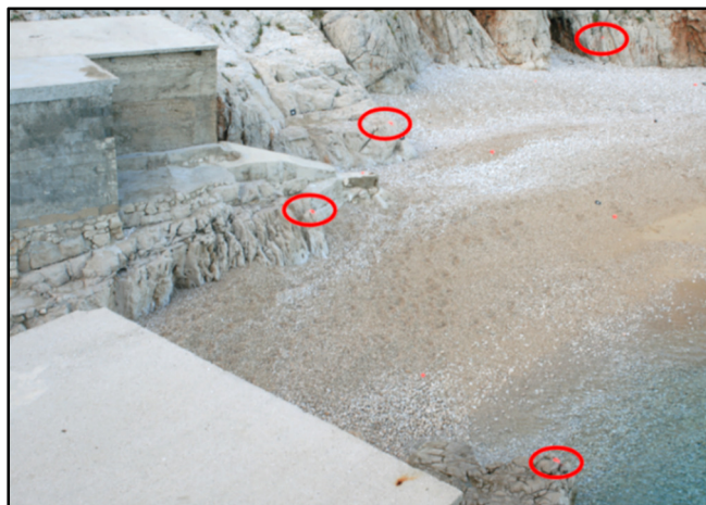
Slika 5.6. Fiksne kontrolne točke (GCP) na žalu Klančac kod Brseč označene su crvenim krugom
