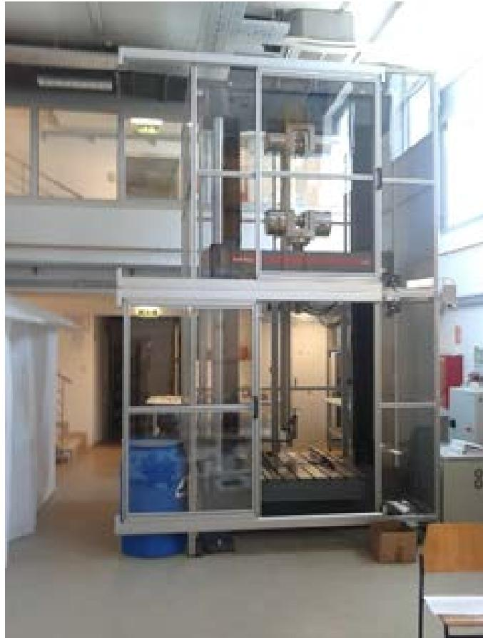
**Kratak opis opreme** Univerzalni tlačno-vlačni stroj za ispitivanje (kidalica) Zwick Z 600E kapaciteta je 600 kN i pokretan je elektromotorom. Kidalica je koncipirana tako da ima dva radna prostora. Gornji radni prostor primarno je namijenjen za vlačna ispitivanja, dok je donji radni prostor namijenjen za tlačna ispitivanja i ispitivanja na savijanje.
