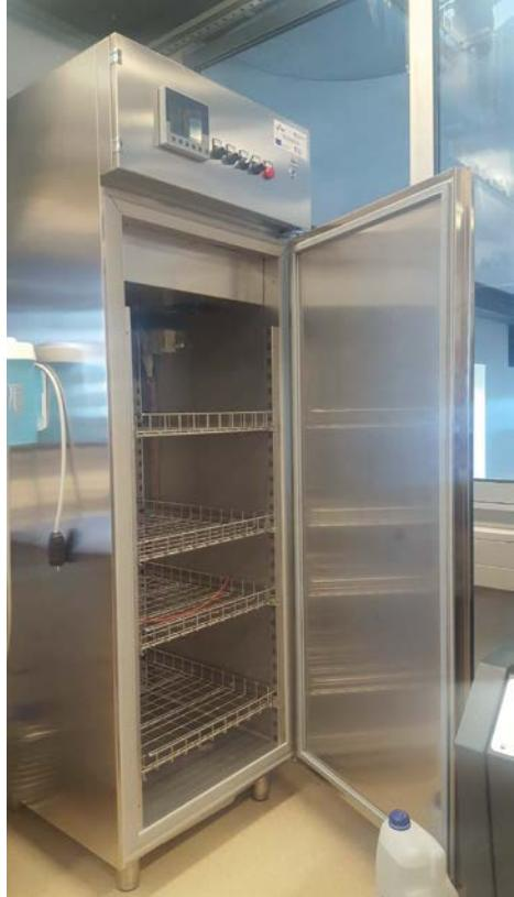
Namjena opreme Uredaj služi za simuliranje uvjeta smrzavanja – odmrzavanja, sušenja – vlaženja.
