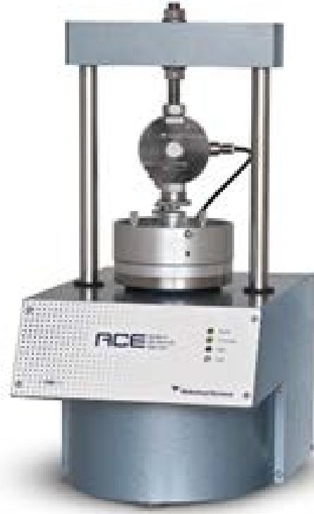
**Kratak opis opreme** Dodatni dijelovi uređaja su: kalup za uzorak sa potrebnim dijelovima (kapa, prsten, porozni kamen, vijci), utezi, LVDT-a za mjerjenje vertikalnog pomaka i bireta za mjerjenje koeficijenta provodljivosti
