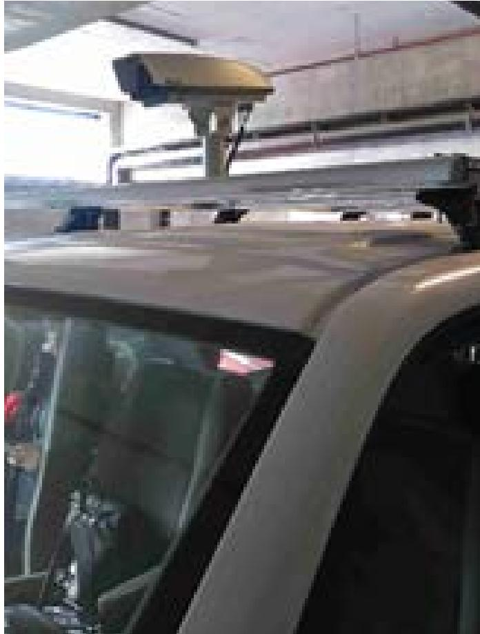
**Kratak opis opreme** Video kamera u vodootpornom kućištu povezana sa sustavom mjerjenja laserskog profiler-a.
