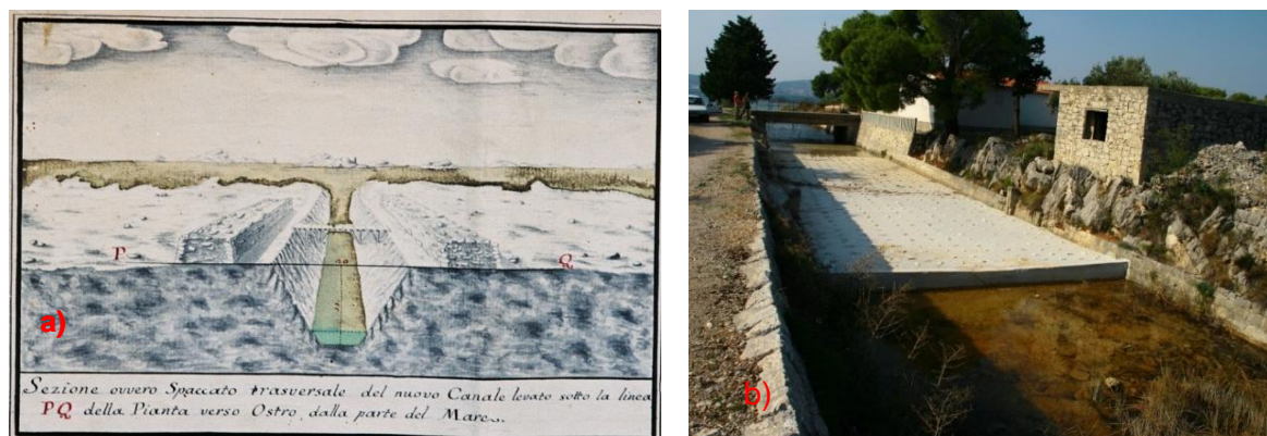
Slika 2.23. Kanal Prosika: a) Poprečni profili kanala Prosika iz 18. stoljeća (fotografija iz arhiva obitelji Borelli); b) Nizvodni dio kanala Prosika s izvedenim fiksnim pragom (fotografija iz arhiva PP Vransko jezero)
